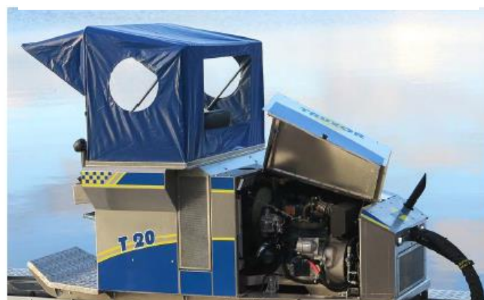
Łatwo dostępna komora silnika ułatwia obsługę.
