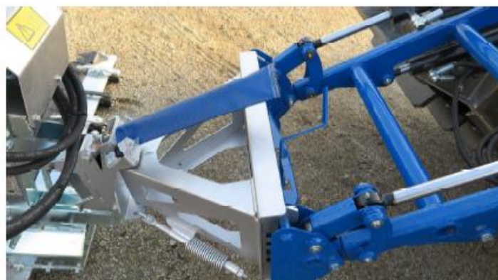
Półautomatyczny szybki uchwyt X4 do szybkiej wymiany narzędzi.
